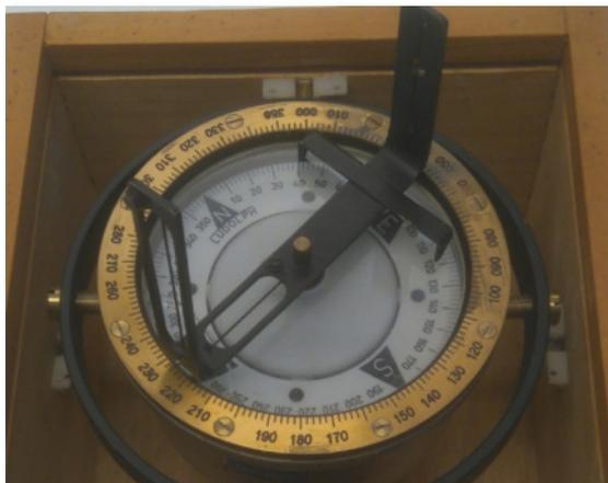
Abb.: Kompass mit Peilaufsatz
