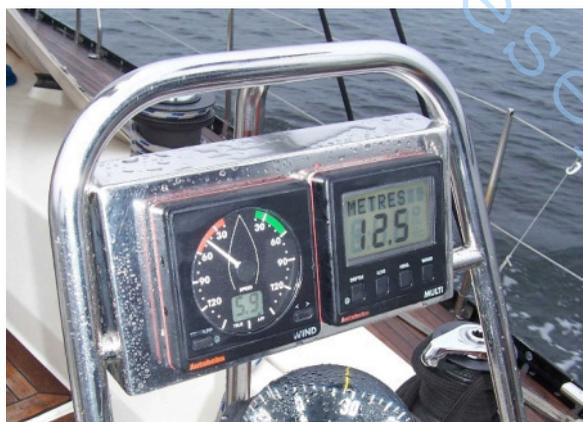
Abb.: Elektronische Wind- und Multianzeige
