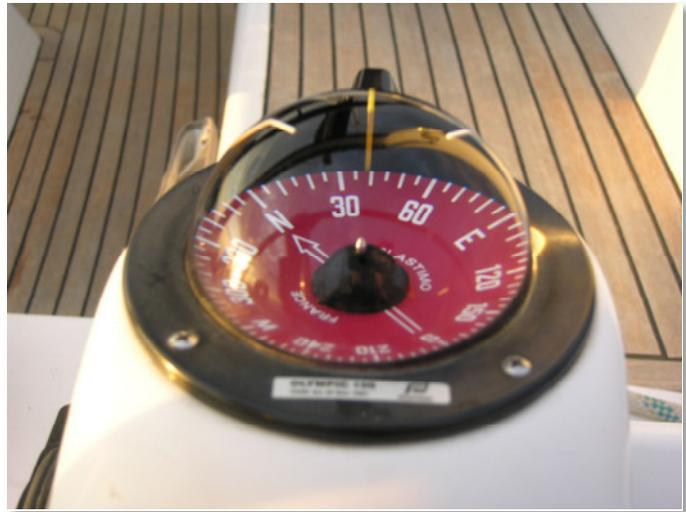
Abb.: Magnetkompass auf einer Segelyacht, MgK  $\approx$  038°
