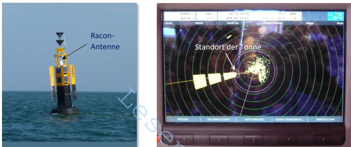
Abb.: RACON-Tonne im Englischen Kanal südöstlich der Isle of Wight:
