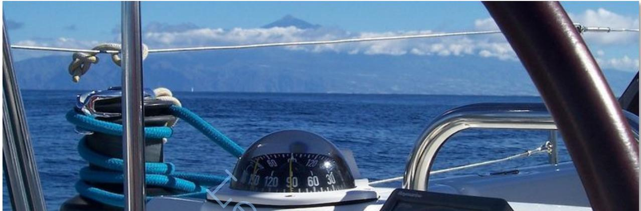
Abb.: Spitze des Vulkans Teide auf Teneriffa peilt in Magnetkompasspeilung 090° bei MgK = 150°
